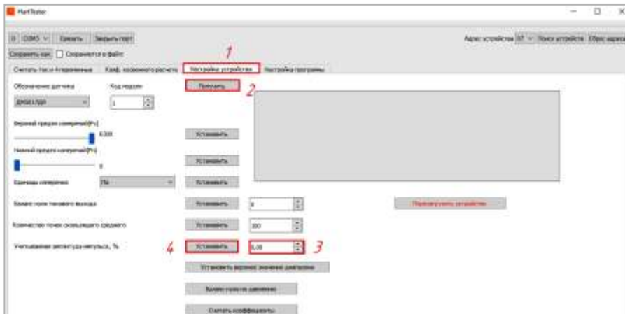
Рисунок 12 – Окно программы при установке учитываемой амплитуды импульса
